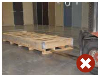
2. Non sollevare il pallet sostenendolo dal lato corto. L'operazione si può effettuare solo se il carrello è dotato di forche lunghe, di almeno 2,5 mt.
